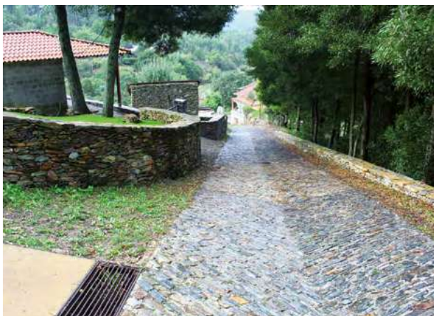
Pavimento destinado ao acesso automóvel em xisto ao cutelo.
