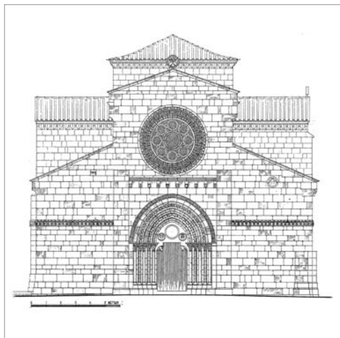
7. Alçado ocidental. A igreja apresenta três naves e transepto.
